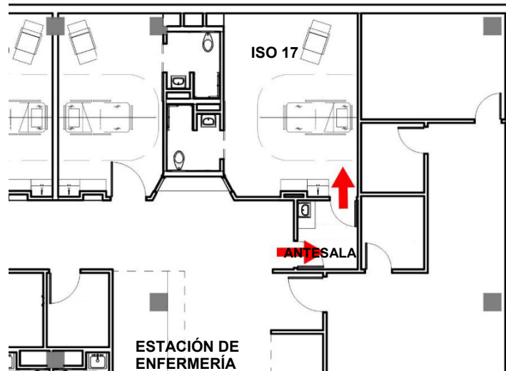
Figura 13. Relaciones de presurización de una antesala de AIIR.
